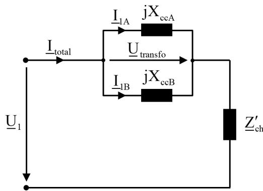
La démarche est très proche de celle de l'exercice *Transformateur Triphasé 1*. La seule grosse différence vient du fait qu'il faudra calculer l'impédance équivalente du circuit en tenant compte de la mise en parallèle des 2 transformateurs.
